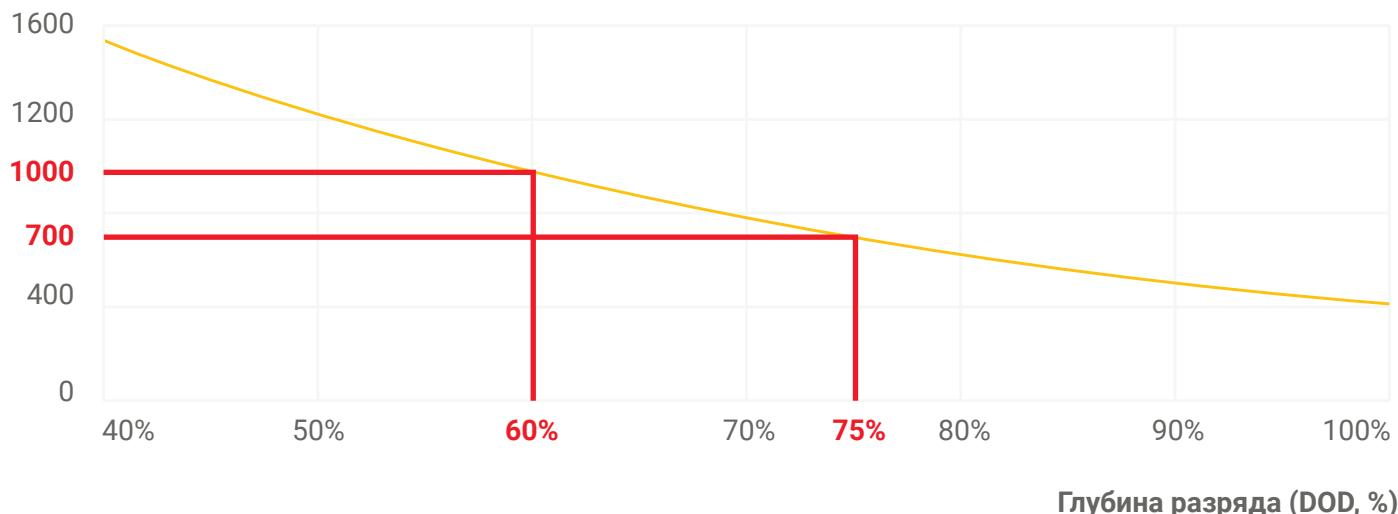
Срок службы аккумулятора (количество циклов заряда/разряда) зависит от того, насколько глубоко разряжается аккумулятор. Если при эксплуатации аккумулятора разряжать его полностью (глубокий разряд – 80% и более процентов её ёмкости), то количество доступных циклов будет минимальным, если же АКБ постоянно разряжать только наполовину, то количество циклов значительно возрастает
